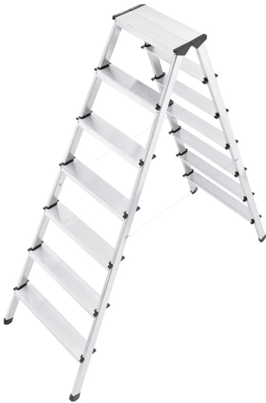
**Escabeau alu double accès avec marches aluminium à profilés longitudinaux antidérapants - Liaison de sécurité entre les marches et les montants à rivetage haute technologie - Sabots emboîtables antidérapants - Deux solides câbles de maintien - Faible encombrement en position pliée**
