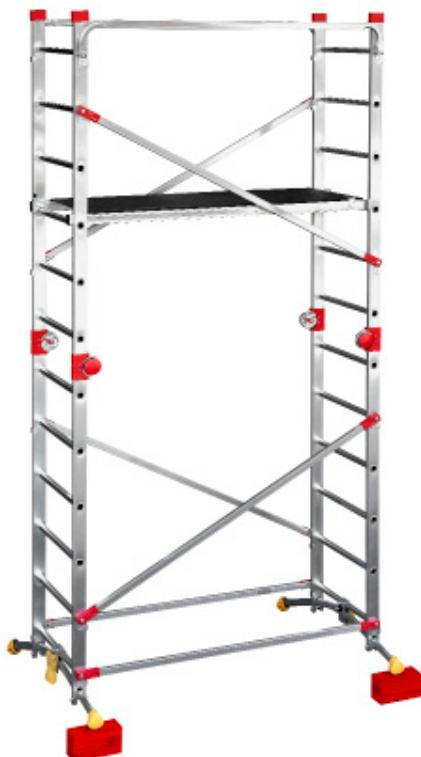
Échafaudage aluminium multifonctions - Rattrapage de niveau et compensation des terrains en pente grâce au système pédale "Lot-system" - Utilisation en échelles simples, doubles, établi et petit échafaudage intérieur - Système de montage rapide Fast & Lock - Charge garantie 150 kg - Hauteur d'accès maximum 4,30 m - Norme E85-200 et EN131-4
