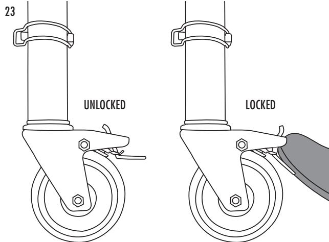
Les roues doivent toujours être tournées vers l'extérieur pendant le montage et lorsque l'échafaudage est utilisé (stabilité maximale). Le frein doit être mis. Appuyez sur le frein avec votre pied pour l'enclencher, et relevez-le pour le déverrouiller.
