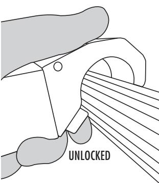
Les lisses se clipsent automatiquement en les poussant sur les barreaux du cadre. Vérifiez qu'elles sont bien enclenchées. Pour déverrouiller, appuyez sur le cliquet.
