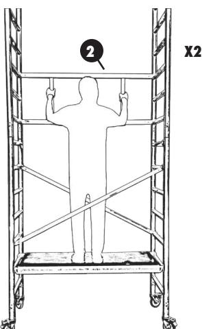
Montez le double garde-corps sur les barreaux inférieurs de chaque plan d'échafaudage intermédiaire. Vérifiez qu'il soit bien enclenché (voir fig. 21).
