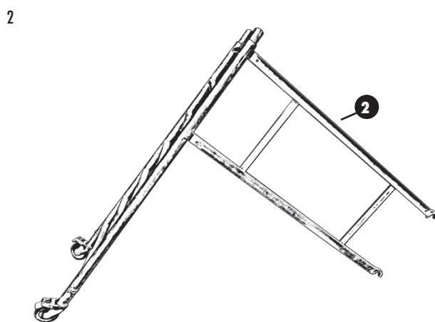
Clipsez le double garde-corps sur les barreaux supérieurs du plan à 7 échelons avec les roues. Vérifiez qu'il soit bien enclenché (voir fig. 21).
