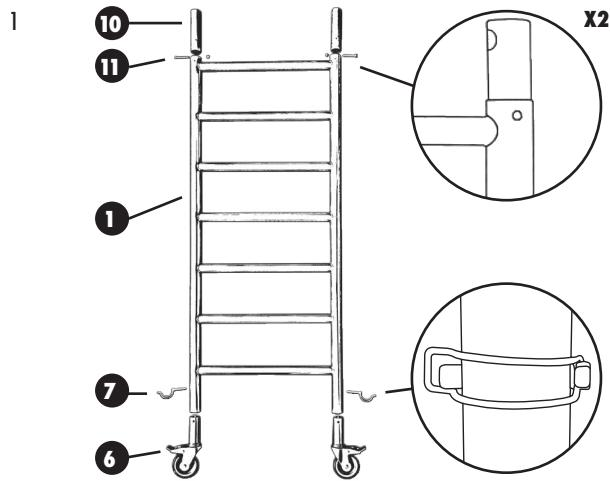
Retirez les embouts de protection des plans d'échafaudage 7 échelons. Montez les roues sur deux plans d'échafaudage. Verrouillez-les à l'aide des goupilles de sécurité. Fixez les tubes de connexion en haut des deux plans à l'aide des vis et des écrous fournis.
