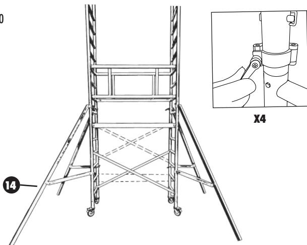
Placez les contreventements croisés 2 barreaux plus bas et montez le plancher sur le 6e barreau à partir du bas. Montez les stabilisateurs en les écartant autant que possible vers l'extérieur et serrez fermement les colliers à la main en deux point pour chaque stabilisateur. Les stabilisateurs doivent toucher le sol.
