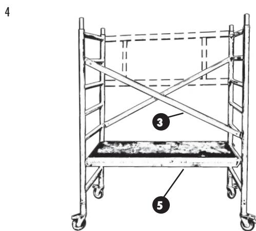
Montez les 2 contreventements en commençant par le 3e barreau en partant du bas. Vérifiez que les diagonales soient bien endenchemées (voir fig. 21). Refrez le double garde-corps. Positionnez les roues correctement et immobilisez-les à l'aide du frein (fig. 23). Installez le plancher au niveau du 2e barreau en partant du bas du cadre. Vérifiez que les crochets de sécurité soient verrouillés (voir fig. 21). Immobilisez les roues (voir fig. 23).
