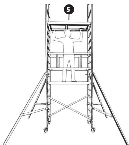
Montez la seconde plateforme sur le 14ème échelon de l'ensemble monté, juste en dessous de la réhausse à deux échelons. Vérifiez que les crochets de sécurité soient verrouillés (voir fig. 22).
