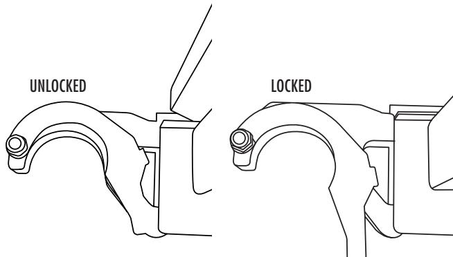
Les deux côtés du plancher sont équipés de crochets de sécurité. Ces crochets doivent se verrouiller automatiquement. Vérifiez qu'ils sont bien verrouillés. Pour déverrouiller, relevez le crochet.
