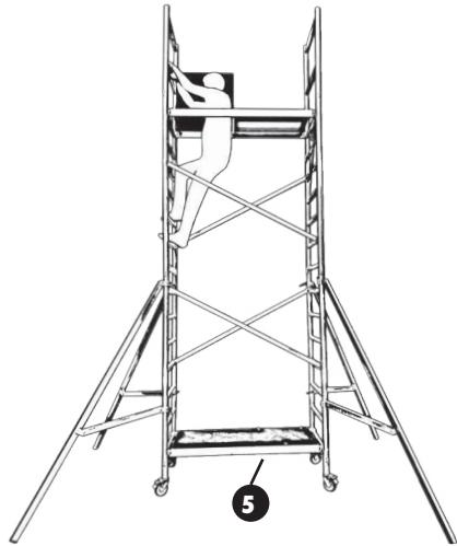
Montez la plateforme que vous venez de retirer sur le barreau du bas. Vérifiez que les crochets de sécurité soient verrouillés (voir fig. 22). Montez par la trappe et restez au niveau de l'ouverture.
