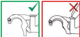
Vérifiez que les crochets de sécurité du plancher sont verrouillés.
