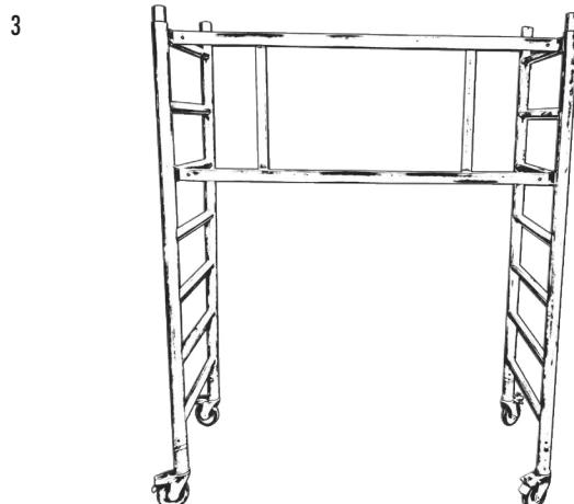
Relevez l'autre plan d'échafaudage opposé et enclenchez le double garde-corps sur celui-ci pour stabiliser l'ensemble. Vérifiez que le double garde-corps soit bien enclenché (voir fig. 21).
