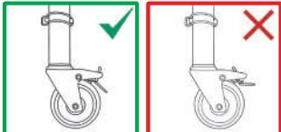
Vérifiez que les roues soient orientées vers l'extérieur et immobilisées à l'aide des freins.
