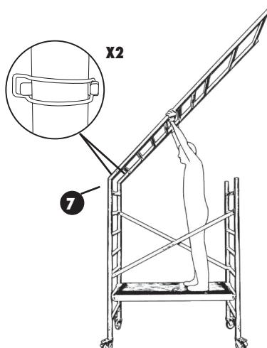
Montez sur le plancher et, depuis l'intérieur, installez le plan d'échafaudage 7 échelons et la réhausse déjà assemblés sur les tubes. Verrouillez à l'aide des goupilles de sécurité.
