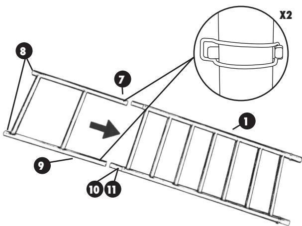
Sur les 2 plans d'échafaudages restant, Fixez les tubes de connexion en haut de chaque plan à l'aide des vis et des écrous fournis. Puis montez les réhausse à 2 échelons sur ces plans et verrouillez-les à l'aide des goupilles de sécurité.
